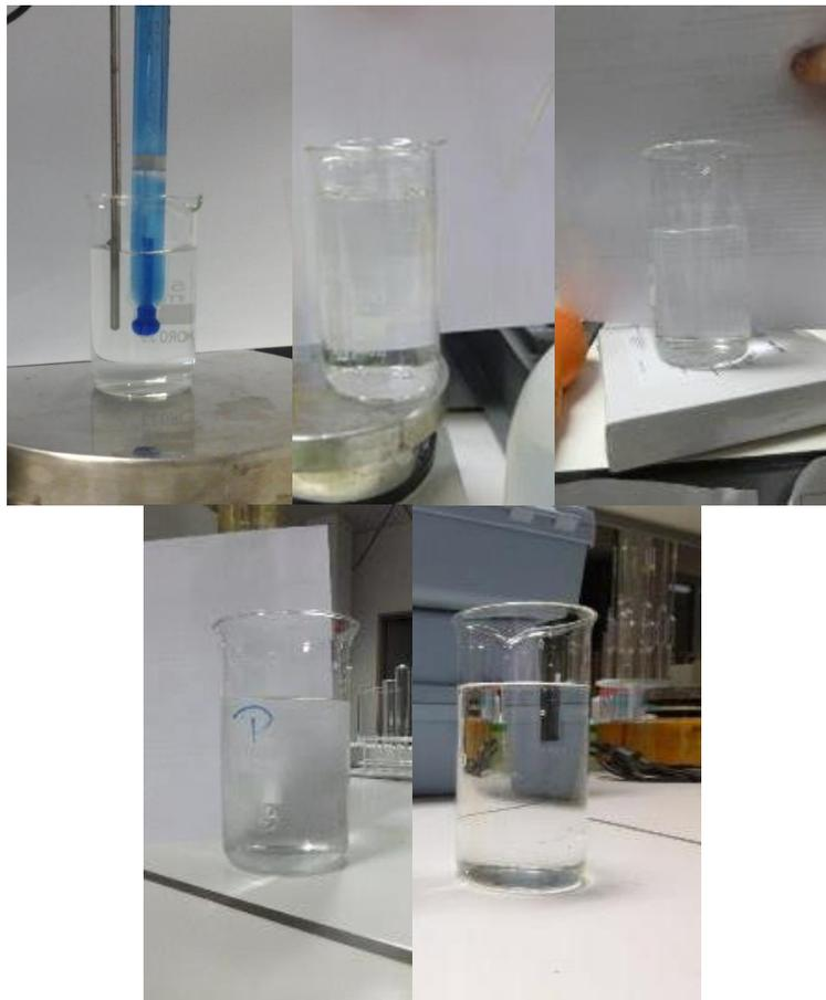
**Figure 6 : Eau déminéralisée après passage sur la membrane VAEPLAN V-FR respectivement après 7 – 14 – 21 – 28 - 35 et 42 jours d'exposition**
