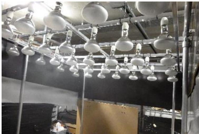
Figure 3 : Lampes UV OSRAM Vitalux 300 W
